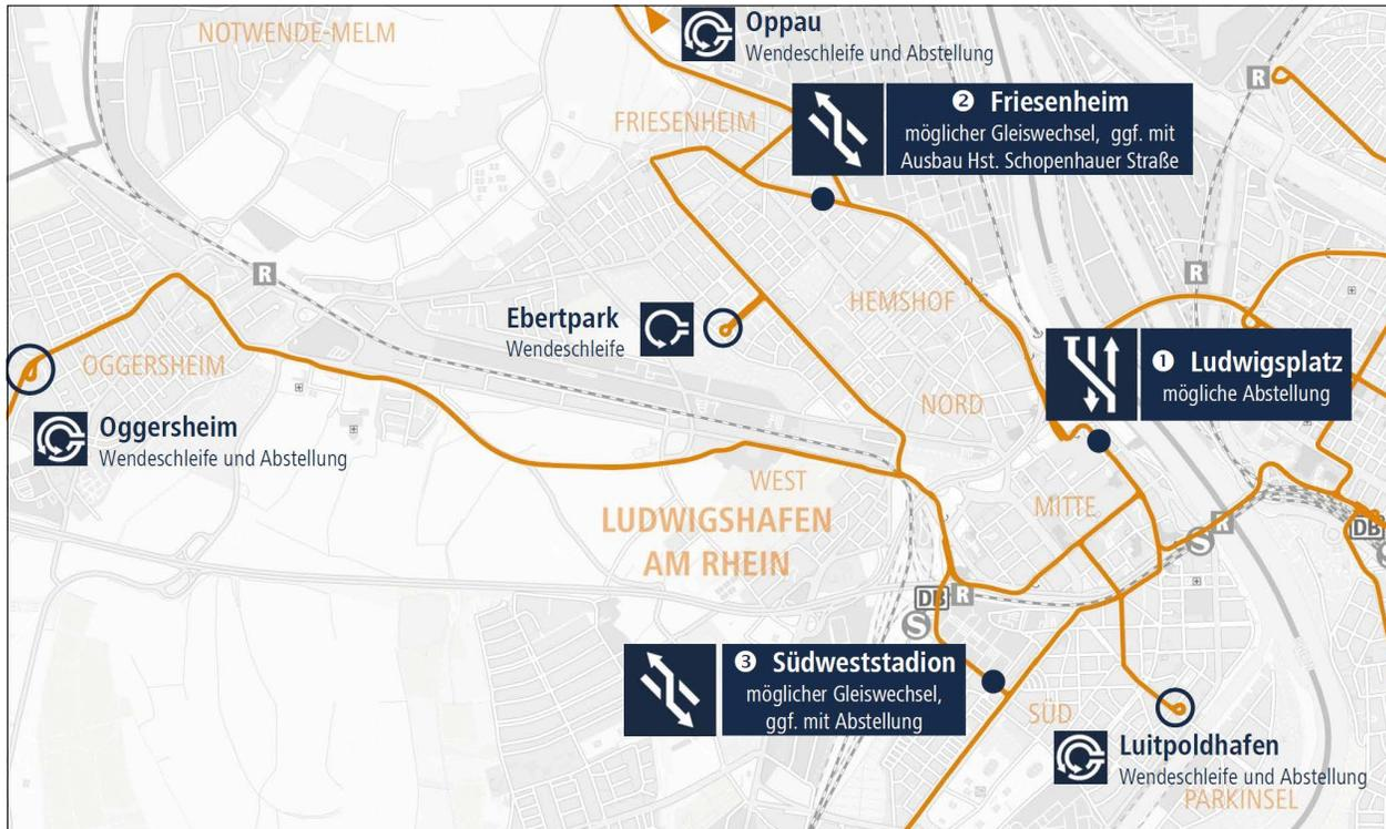
Abbildung 14: Mögliche Weichenverbindung für „Kurzwenden“ mit Zweirichtungsfahrzeugen (ATKIS© Basis-DLM ©, Vermessungsverwaltung der Länder und ATKIS © DLM250, DLM1000 des BKG 2006 (p) geoGLIS© / © GeoBasis-DE/BKG 2012 (p) Intergaph)
