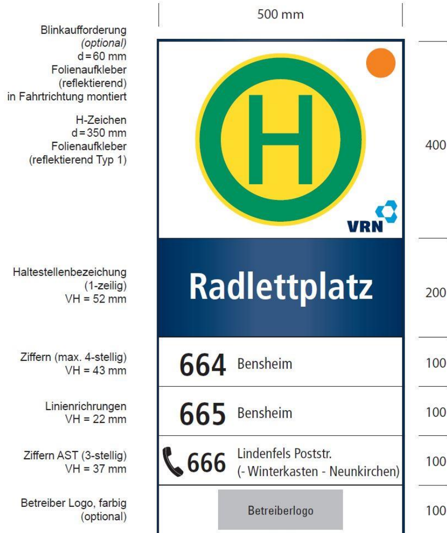
Abbildung 37: Wechselschildsystem mit gewölbter Oberfläche (höherwertiges System)
