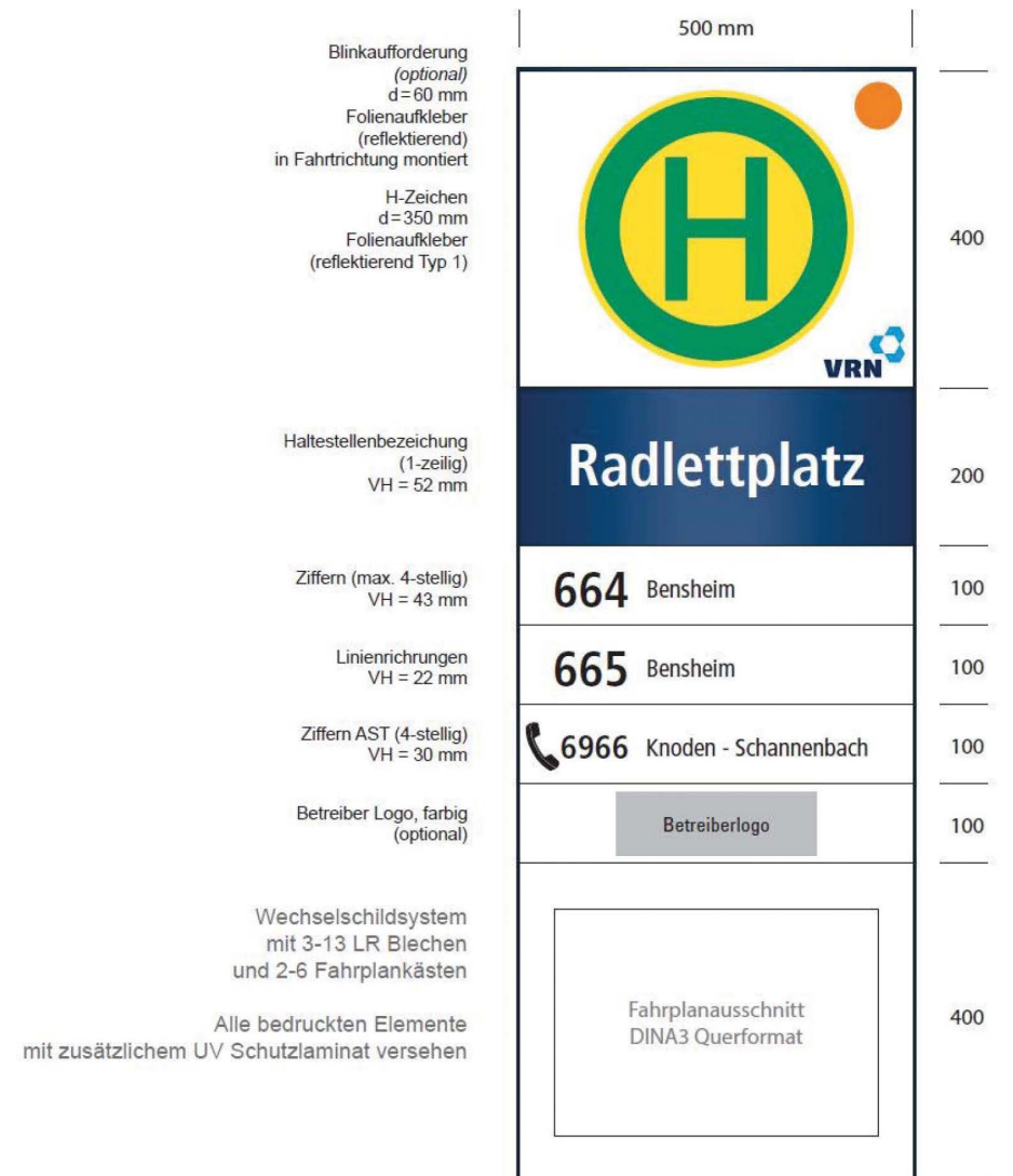
Abbildung 42: Wechselschild mit gewölbter Oberfläche als Stèle (höherwertiges System)
