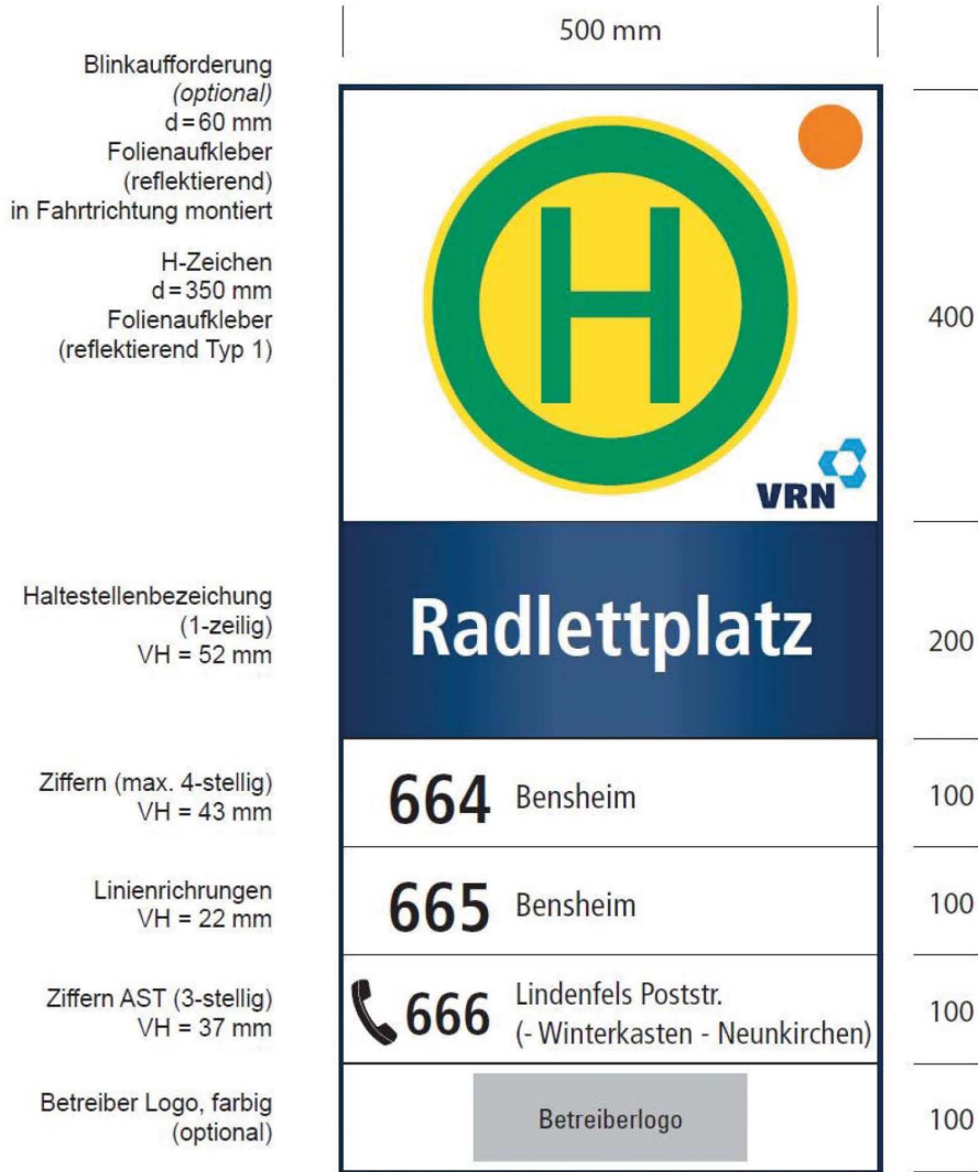
Abbildung 41: Wechselschildsystem mit gewölbter Oberfläche (höherwertiges System)
